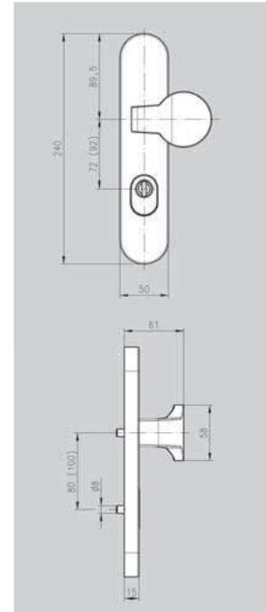
Die Schutzbeschläge SI 1720 (mit festem Knopf) und SI 1721 (mit Drücker) sind speziell für die Kombination mit dem OGRO Panic-Hardware-System **PHA 2500** ausgelegt.
